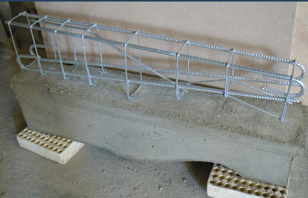
Las Armaduras Galvanizadas en productos y estructuras de hormigón pueden proporcionar grandes beneficios. En ambientes agresivos, puede evitar la necesidad de incrementar el recubrimiento de hormigón. Cuando se requieran diseños de hormigón más livianos y delgados, la armadura galvanizada protegerá contra la carbonatación.
